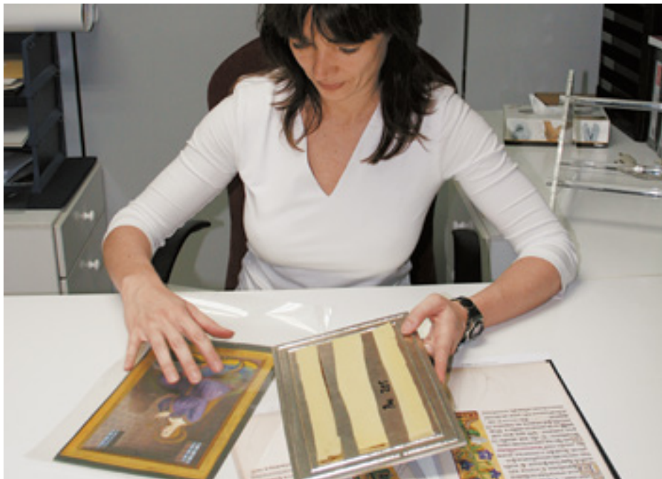
En haut : Dans la bibliothèque, les épreuves couleur sont minutieusement comparées auprès du manuscrit afin d'assurer que chaque enluminure est exacte à l'original. En bas : Chaque étape de la fabrication est précédée d'un contrôle des outils, ici les films et les tampons avant l'estampage de l'or. POUR TOUS LES VISUELS : ©M. MOLEIRO EDITOR/BNF.
